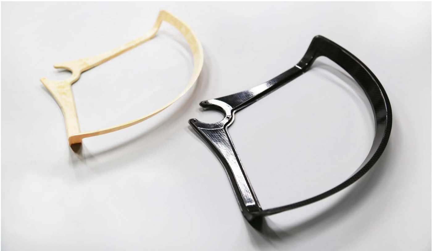
↑ ドローン用プロペラガード 左：エポキシフォーム（コア材） 右：表層が CFRP のサンドイッチ構造
